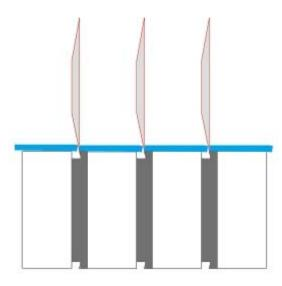
そして二つ目がギャングスリット方式 ギャングスリット方式は簡単にいうとパスタを切るシュレッターです。 刃の幅が製品の幅になります。
