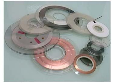
細くするだけでは 後工程に迷惑をかけます。 崩れないように両端面を板でおさえます。後のハンドリングや 輸送上の トラブルもこれで解消します。
