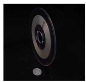
マイクロスリット加工の最小は0.4mm。 何よりも大事なのは端面の品質と 材質 特に複合材料はそれぞれの特性を加味してスリット加工するので
